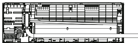
Труба свіжого повітря
